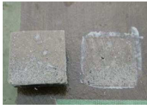
破断面にレイタンス
